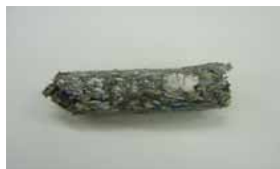
RPFに加工し、ボイラーのエネルギーとして利用
